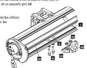
y Seguidamente colocamos el tejadillo cofre (33) en el perfil cofre (1) a través de las ranuras existentes en ambos perfiles, ayudándonos de dar un giro tal como indica la figura.
